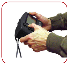
Displayen kan monteras loss från huven för att underlätta avläsning.
